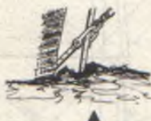
Abb. 4 Wasserstag-Befestigung am Steven
