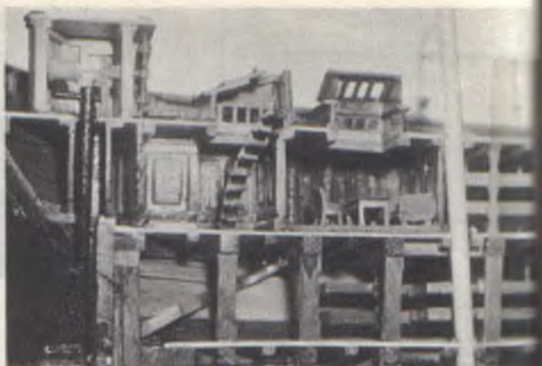
Abb. 7 Heckpartie mit Ruderhaus, Rudereinrichtung und Niedergang in die 1. Kl. Kajüte am Theone-Modell aus dem Verkehrsmuseum
