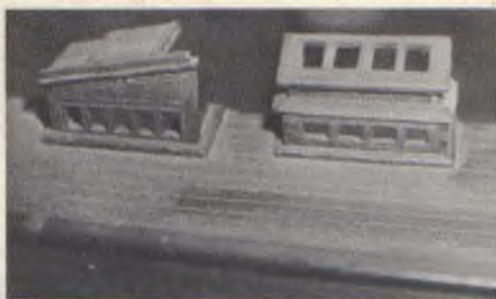
Abb. 6 Halbdeck, Oberlicht und Niedergang zur 1. Kl. Kajüte am Theone-Modell aus dem Focke-Museum, Bremen.
